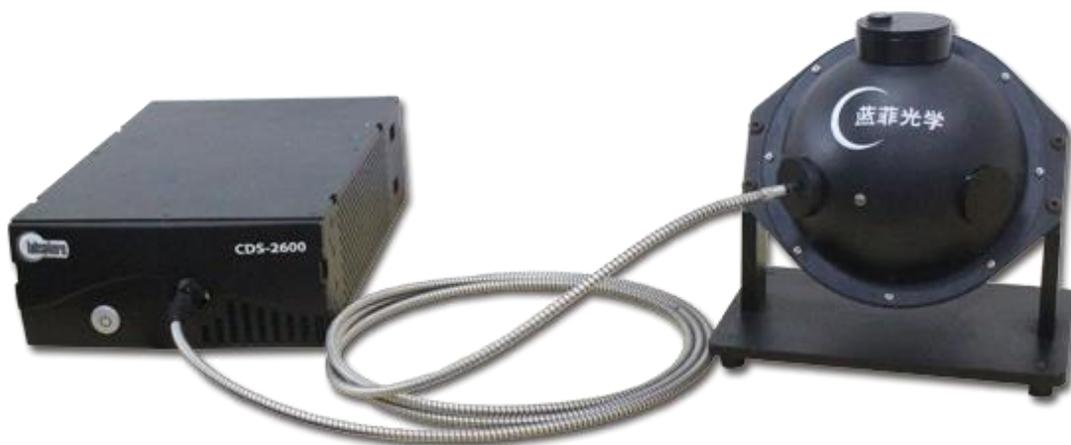
光致发光可以描述为物质吸收光子跃迁到较高能级的激发态后返回低能态，同时放出光子的过程。而在现阶段光致发光材料的研究中，对荧光量子效率的计算非常重要，因为这是反映光致发光材料发光能力的重要特征指标。荧光量子效率又称荧光量子产额和荧光效率。一般情况下，荧光量子效率、荧光量子产额与荧光效率描述等价。定制光致发光荧光量子效率测试系统是对光致发光材料的发光特性，发光效率等光学性能进行测试的系统，可以测薄膜，液体和粉末。
