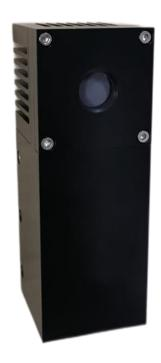
LFTPM-035-L是一款带热电堆传感器的激光功率计,用于测量高能量密度脉冲激光束,能够连续测量高达35 W的激光功率。它的光谱平坦覆盖了190nm到20 μ m的波长范围。它具有15毫米的有效直径并且能够测量10mW到35W的功率。它具有两个用于夹具或者平板安装的M6螺孔。这款产品通过USB线连接电脑软件使用。
